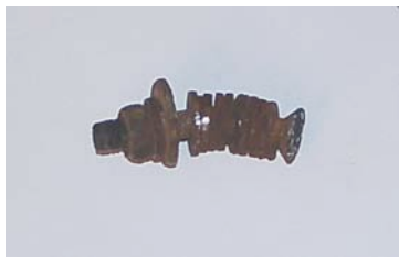
Versuch der Verschraubung eines Kotflügels an einem Austin Healey vor der Restaurierung durch Oldtimer Rehberger
