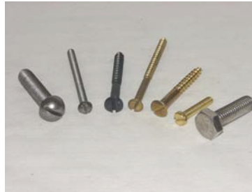
von links nach rechts: halbrunde Schlitzschraube metrisch, Linsenkopf Stahl, Senkkopf Schlitz Stahl, Senkkopf Schlitz Holzschraube, Messingschlitz halbrund flach, Maschinenschraube Sechskant zöllig
