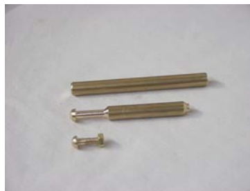
oben: Messing-Rohling, mitte: halbfertiger Rohling ohne Gewinde, unten: fertige Schraube mit Mutter
