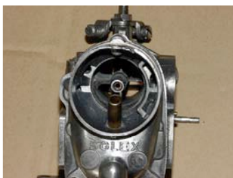
Foto: Corinna Illia Solex-Vergaser nach der Ultraschall-Reinigung
