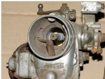
Foto: Corinna Illia Solex-Vergaser vor der Reinigung
