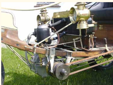
Der De Dion Bouton Einzylinder mit 942 ccm.
