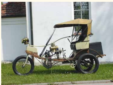
Der La Nef in der Seitenansicht. Diese extravagante Karosserieform nennt sich bacquets tulipe.
