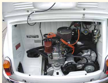
Der ursprüngliche 19 PS-Motor wurde auf Kundenwunsch ersetzt durch einen Fiat 850 Coupé-Motor mit jetzt 46 PS ! Dabei wurde der Rechtsdreher zum Linksdreher umgebaut.
