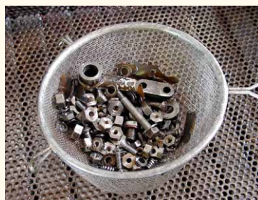
Vorwahlgetriebe in Nudelsieb an Reinigungsflüssigkeit im Waschtisch
