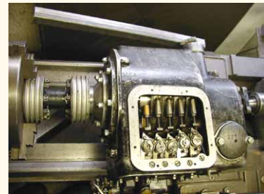
Repariertes Vorwahlgetriebe beim Probelauf in unserer Drehbank für den Funktionstest vor dem Einbau.
