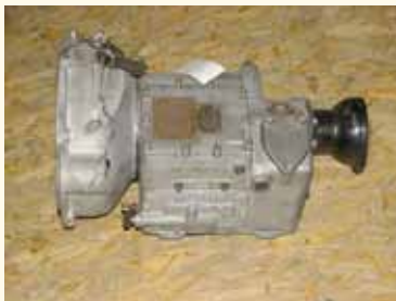
Wilson-Vorwahlgetriebe zum AT. Die Glocke und der Anschluss zur Kardanwelle können abgenommen und individuell angepasst werden.
