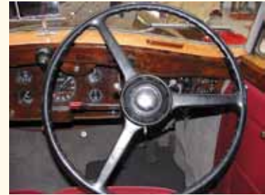
Eingebaute, fast unsichtbare Servolenkung bei einem RR P III
